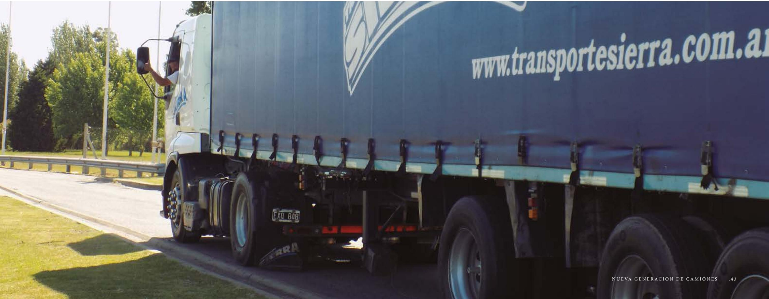
Los camiones pueden ser rígidos -cuando no se puede separar la caja de la cabina- y tener dos o tres ejes. Están diseñados para el transporte de carga relativamente liviana, y para distancias cortas o medias. Generalmente se utilizan para el transporte de cargas menores o frágiles, como por ejemplo para gastronomía.
